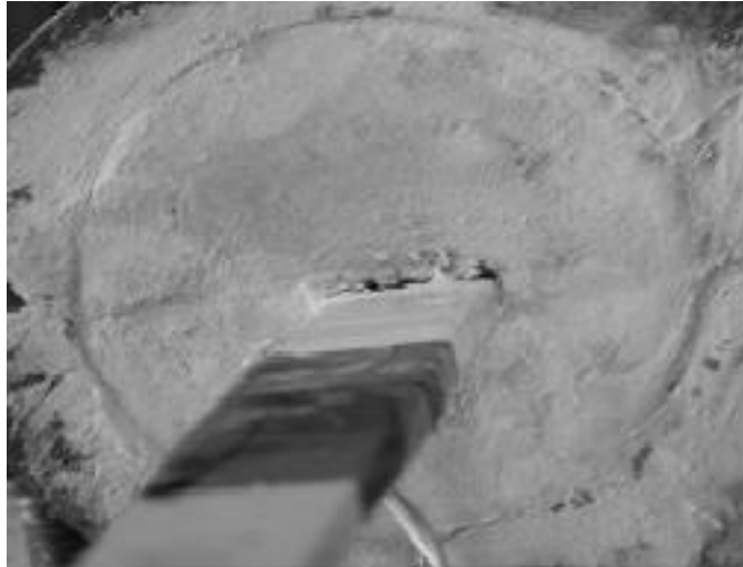
Figura 5- Conexão haste de alumínio-bloco depois do teste de vibração livre.
