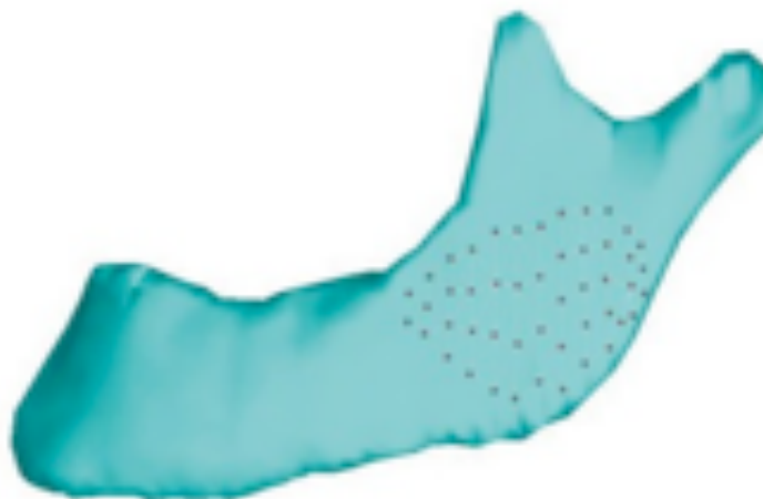
FIGURA 10. Exemplo do esquema de distribuição das forças aplicadas na região do Masseter.
